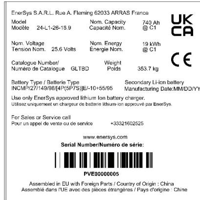
Beispiel für ein EMEA-Typenschild
