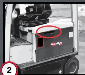
2 Connectez les câbles du chargeur à la batterie à l'aide de la connectique de charge de batterie dédiée. Ne chargez pas avec un câble reliant la batterie à l'équipement.
