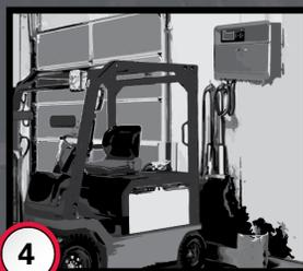
4 Si la batterie est DÉSACTIVÉE, le chargeur réactive automatiquement la batterie et commence à charger.
