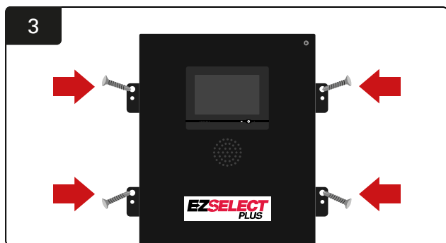
Namestitev krmilne omarice Krmilno omarico namestite na steno v višini oči s štirimi vijaki/sidrišči in vodno tehtnico.
