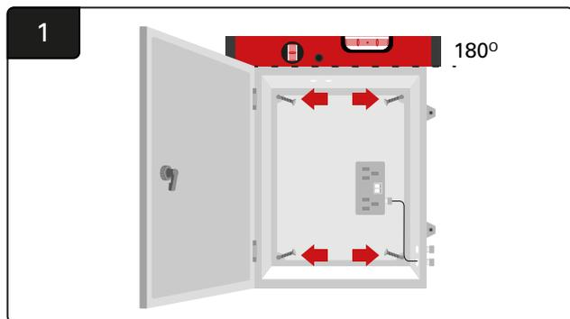
1 Montare l'alloggiamento del Router vicino alla centralina e all'ideale fonte di alimentazione utilizzando quattro viti, appositi ancoraggi a parete e una livella.
