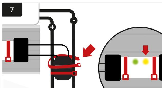
Fissare il connettore con fascette fermacavo. Verificare che il LED ambra si accenda sul CMD con una batteria collegata.
