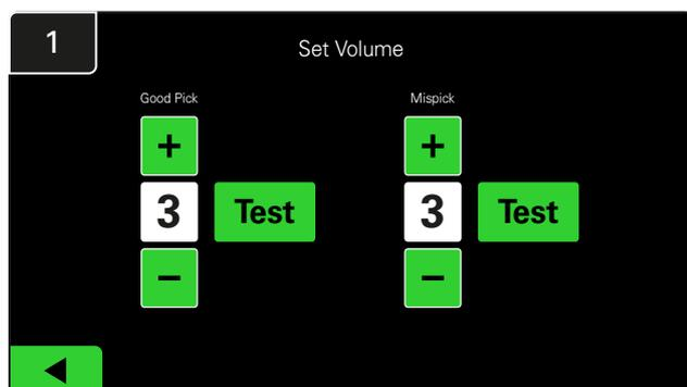
Testare la funzionalità del dispositivo sonoro scollegando una batteria o premendo il pulsante **Test** nella schermata Set Volume (Imposta volume).
