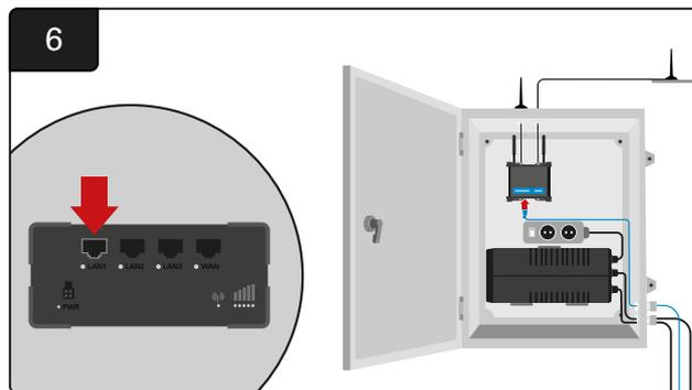
Collegare il cavo dati dalla centralina alla porta Ethernet LAN del router.
