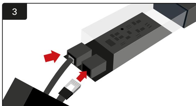
Inserire il cavo dati del primo CMD in una presa sul primo CMD. Collegare il cavo dati successivo all'altra presa.
