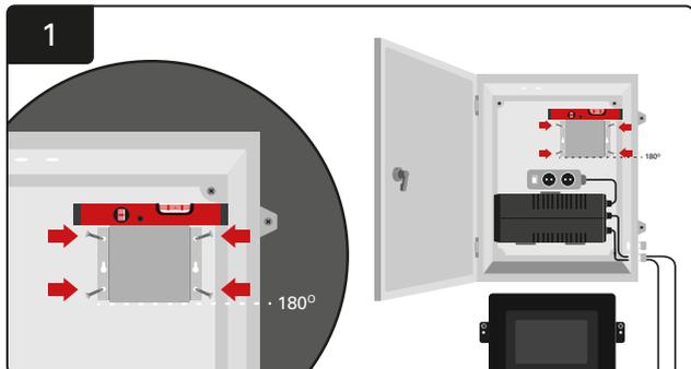
Montare il TV Driver nell'armadietto (o a parete) utilizzando quattro viti/ancoraggi e una livella.
