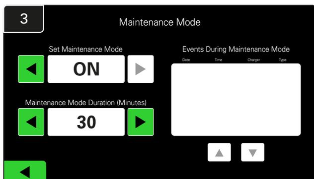
La durata della modalità di manutenzione può essere impostata tra 5 e 120 minuti. Un timer automatico riporta il sistema alla modalità di funzionamento normale.
