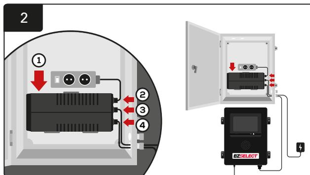
Montare il gruppo di continuità a parete sotto le prese shuko dell'armadietto, collegarlo alla fonte di alimentazione e alla prolunga della presa shuko e collegare il cavo di alimentazione della centralina al gruppo di continuità.
