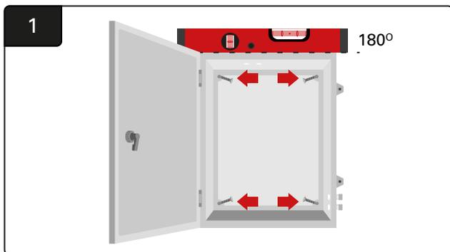
Montare l'armadietto vicino alla centralina e all'alimentatore adatto utilizzando quattro viti, appositi ancoraggi e una livella.
