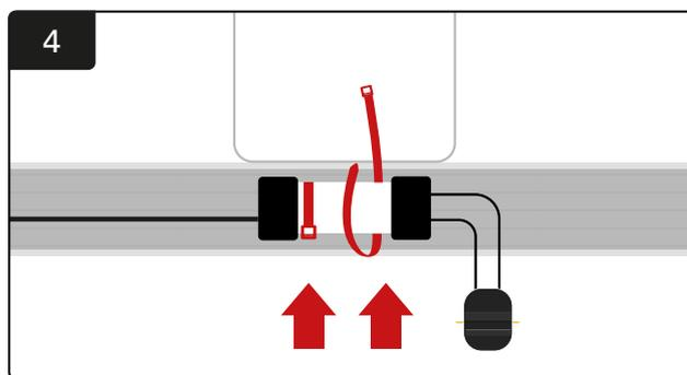
Fissare il CMD con fascette fermacavo in modo che sia visibile, sicuro e fissato.
