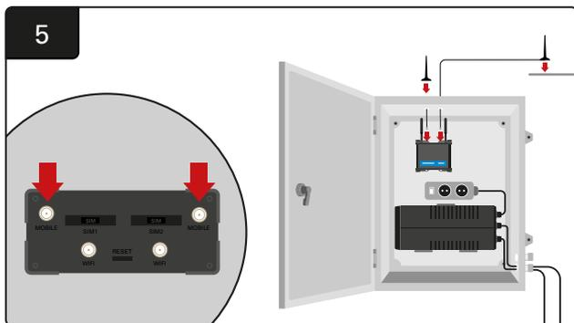
Collegare le due antenne cablate ai connettori mobili del router. Collocarne una sulla parte superiore dell'armadietto e l'altra il più in alto possibile.
