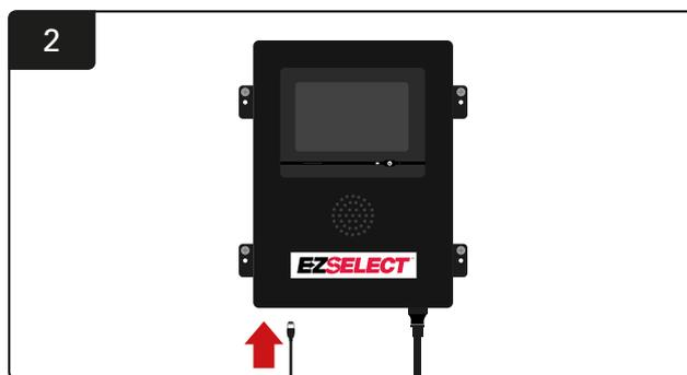
Inserire il cavo dati del primo CMD nella porta inferiore in una delle prese bus libere della centralina.
