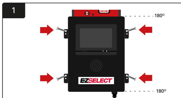
Fissare la centralina alla parete all'altezza degli occhi utilizzando quattro viti/ancoraggi e una livella.
