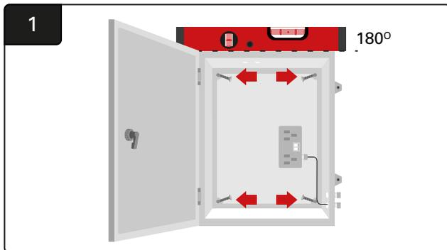
Montez le boîtier du routeur à proximité du boîtier de commande et de l'alimentation électrique appropriée à l'aide de quatre vis, d'ancrages muraux appropriés et d'un niveau à bulle.
