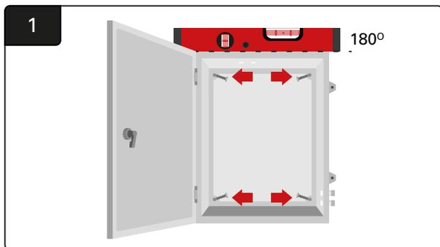
Montez le boîtier proximité du boîtier de commande et de l'alimentation électrique appropriée à l'aide de quatre vis, d'ancrages muraux appropriés et d'un niveau à bulle.
