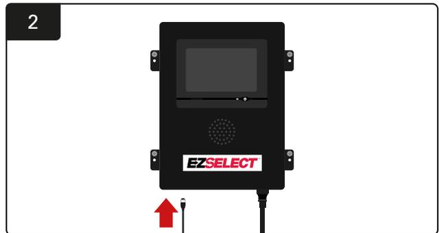
Insérez le premier câble de données CMD dans l'une des prises de bus disponibles dans le boîtier de commande.
