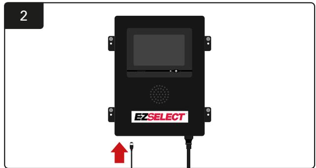
2 Inserte el cable de datos del primer CMD en una de las tomas para bus de la caja de control.
