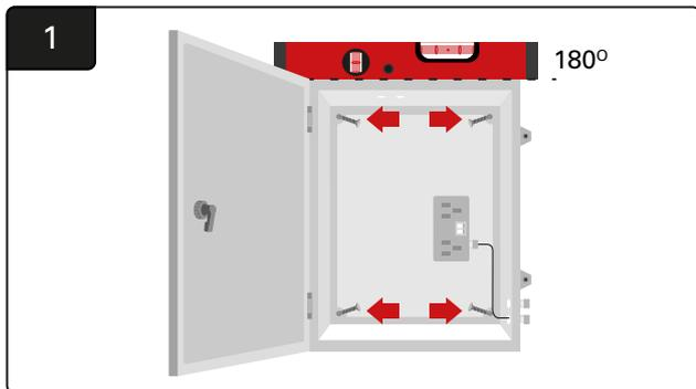
1 Montieren Sie den Routerkasten mit vier Schrauben, geeigneten Wanddübeln und einer Wasserwaage in der Nähe des Steuerkastens und einer geeigneten Stromversorgung.
