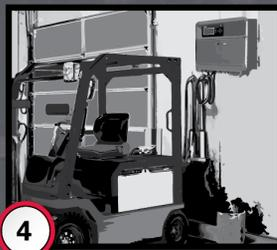
**4** Se la batteria è SPENTA, il caricabatterie attiva automaticamente la batteria e inizia a caricare.
