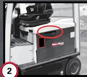
**2** Collegare i cavi del caricabatterie alla batteria utilizzando gli appositi connettori di carica della batteria. Non caricare con il cavo che collega la batteria all'apparecchiatura.
