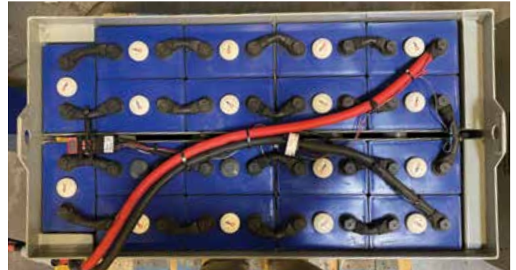
8. ábra: Wi-iQ 4 eszköz végső összeszerelése a 12V-os blokk tálcán
