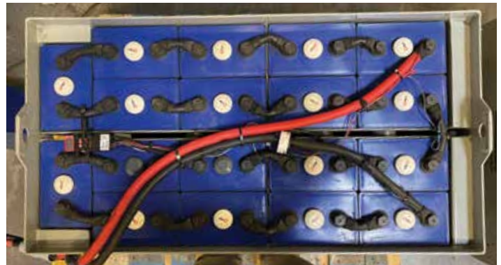
Εικόνα 8: Τελική συναρμολόγηση συσκευής Wi-iQ4 σε κιβώτιο συσσωρευτή με μπλοκ 12V
