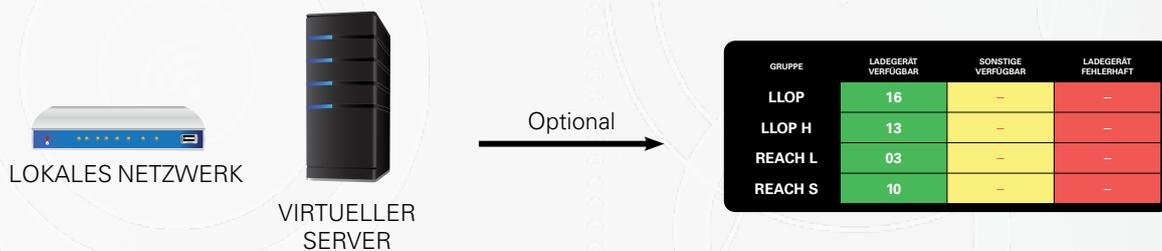
Eine Installation vor Ort ist nicht erforderlich. Die Ladegeräte werden über das Ethernet an das Kundennetzwerk angeschlossen. Das Programm wird auf dem vom Kunden bereitgestellten Server installiert (gleiches Netzwerk wie die Ladegeräte). Dies ist die ideale Möglichkeit für das Management, „Live-Daten“ von jedem Ort aus einzusehen, sei es ein Büro am selben Standort oder von einem anderen geografischen Standort aus. FiBo (First in, Best out) ist in dieser Option optional.
