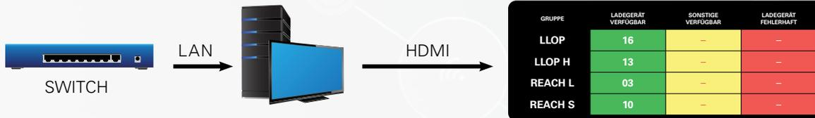
In der Ladestation wird vor Ort ein Netzwerkschrank aufgestellt. Ein PC und ein Switch sind erforderlich, um alle Ladegeräte mit dem PC zu verbinden und das System in Betrieb zu nehmen. Der FiBo-Bildschirm (First in, Best out) wird als zusätzlicher Monitor direkt an den PC angeschlossen. Dieser PC kann optional mit dem Internet verbunden werden, sodass ein Fernabruf möglich ist.
