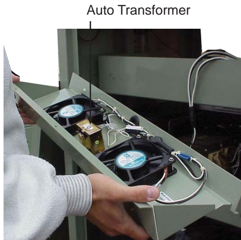
Fig. 5-12, Cooling Fan Panel
