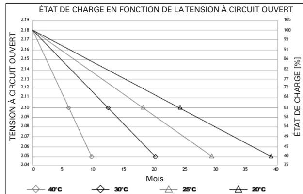
Cependant, il est conseillé d'effectuer une inspection et un contrôle du circuit ouvert après 12 mois et de procéder à une recharge si la tension à vide (OCV) est inférieure à 2,10 V par cellule. Si elle est stockée à des températures supérieures à 30 °C (86 °F), la tension à vide de la batterie doit être vérifiée tous les 6 mois. Le graphique ci-dessus montre la relation entre la température, la durée de stockage et la tension à vide.
