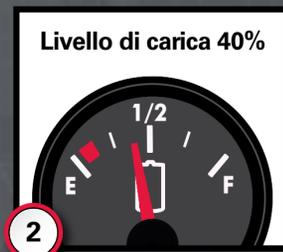
**2** Per massimizzare la durata della batteria, il livello di carica non deve scendere al di sotto del 40%.
