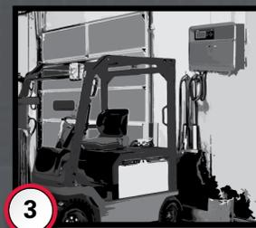
**3** Il biberonaggio ottimizza la durata della batteria NexSys<sup>®</sup> TPPL. Collegare durante i tempi di fermo (quando il veicolo non è in uso).
