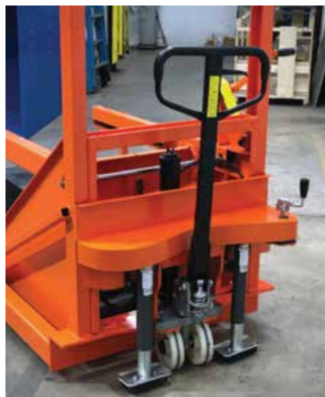
Lisävarusteena saatava käsikammen aktivoima positiivinen jarrujärjestelmä estää työntämisen taaksepäin jarrun ollessa kytkettynä
