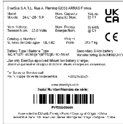
Beispiel für ein EMEA-Typenschild
