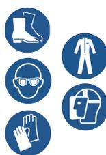
Le scarpe antinfortunistiche, gli occhiali di sicurezza e gli indumenti protettivi sono obbligatori nei locali batterie. Assicurarsi di indossarli sempre. Per il lavaggio e la manutenzione delle batterie dei carrelli elevatori sono necessari guanti di gomma, grembiuli di gomma e protezioni integrali per il viso. Usare sempre cautela e buon senso.
