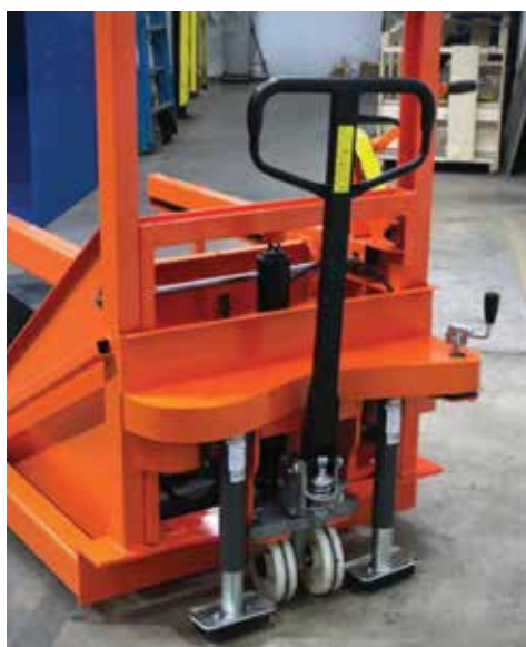
Opcioni pozitivni sistem kočenja koji se aktivira ručno bez povratnog potiska kada je kočnica aktivirana
