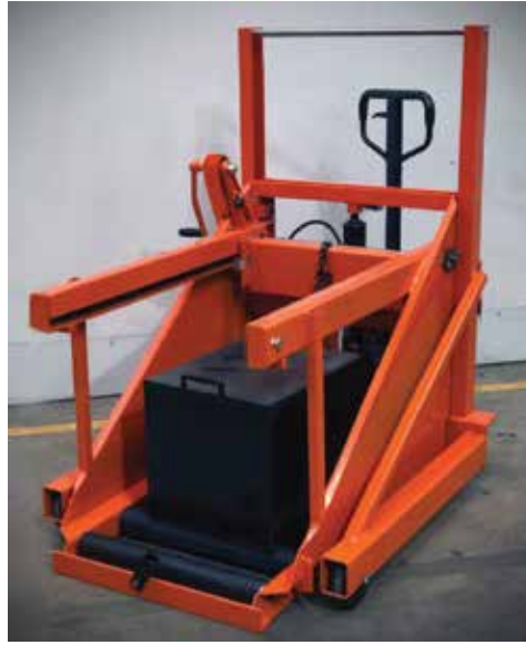
El kumandalarıyla bel yüksekliğinde rahat kaldırma ve indirme
