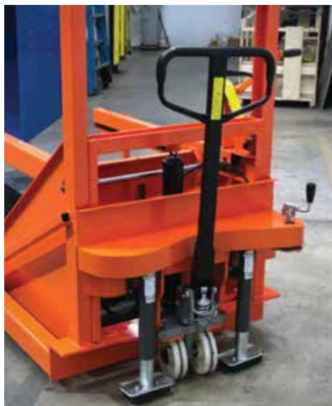
Opcjonalny hamulec dodatni aktywowany za pomocą korby ręcznej zapobiega ryzyku cofnięcia się
