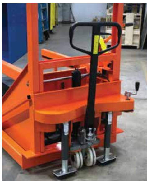
Opcionális hajtókkal működtetett pozitív fékrendszer visszanyomás nélkül a fék behúzásakor
