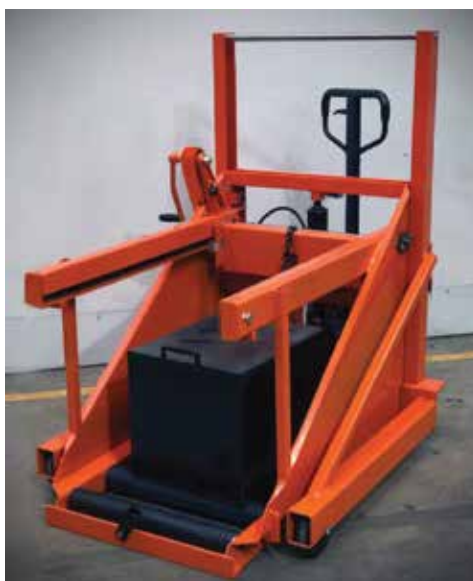
Levage de la charge à hauteur de taille et abaissement très pratiques à l'aide de commandes manuelles
