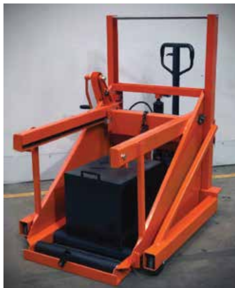
Bequemes Heben und Senken mittels Handbedienung in Tailenhöhe
