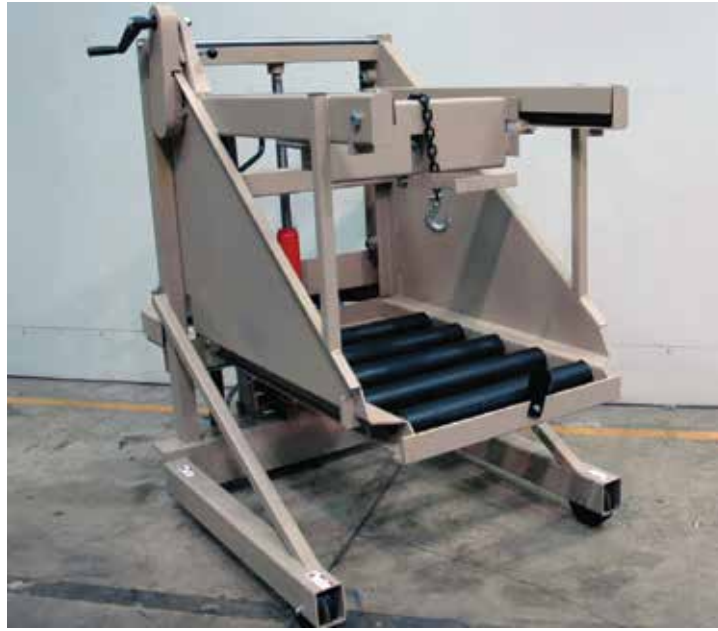
Vorderansicht mit angehobenem Batteriewagen
