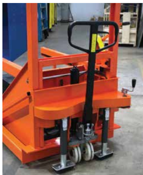
Optionales, im Handkurbelbetrieb aktiviertes formschlüssiges Bremssystem zur Rückstoßverhinderung bei Bremsaktivierung
