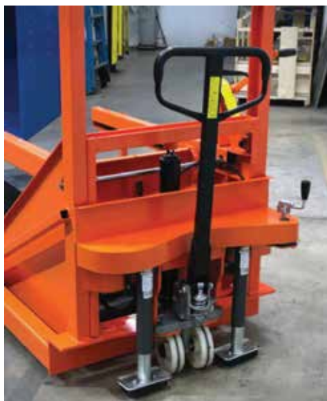
Opcionalni pozitivni sustav kočenja koji se aktivira okretnom ručicom. Ne dolazi do trzanja unatrag ako je kočnica aktivirana
